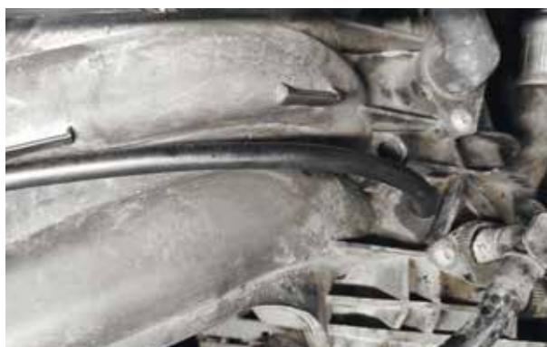
Rys.15 Podciśnienie z kolektora ssącego za przepustnicą
