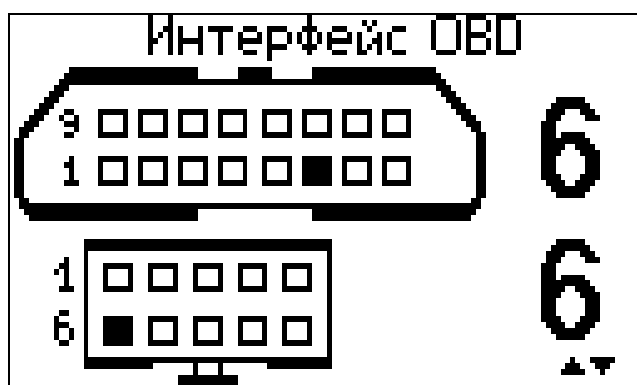
Рисунок 2.3.3: Пример присоединения адаптера STAG-OBD к магистрали CAN (1 из 2)
