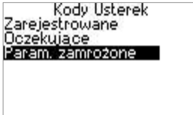
Rysunek 2.6.1: Odczyt chwilowych wartości parametrów pracy silnika, zapisanych w momencie wystąpienia usterki.
