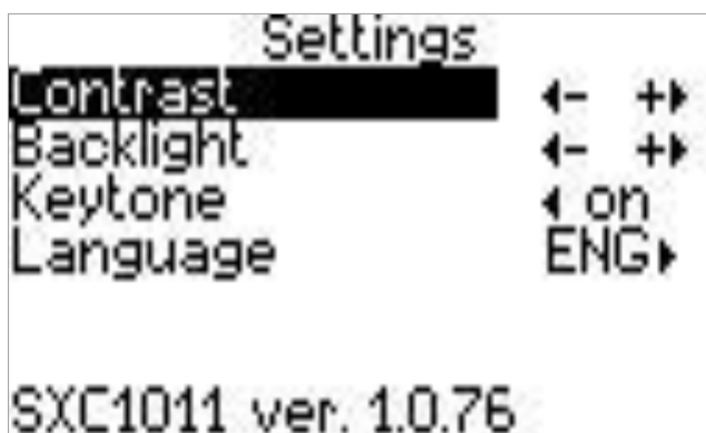
Dibujo 3.1.2 Cambio del contraste de la pantalla LCD.
