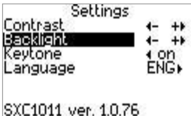
Dibujo 3.1.3 Cambio de la intensidad luminosa del LCD.
