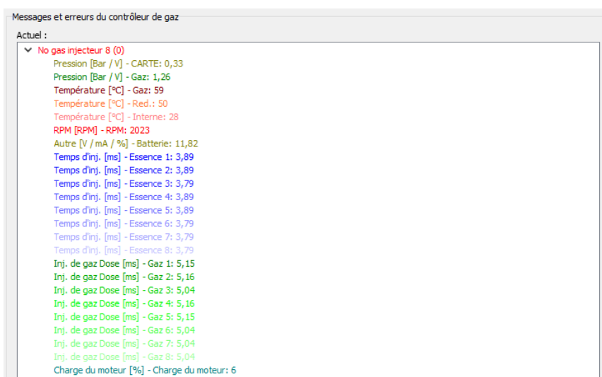
Figure 27 Écran « figé » d'une erreur qui s'est produite au niveau d'un injecteur
