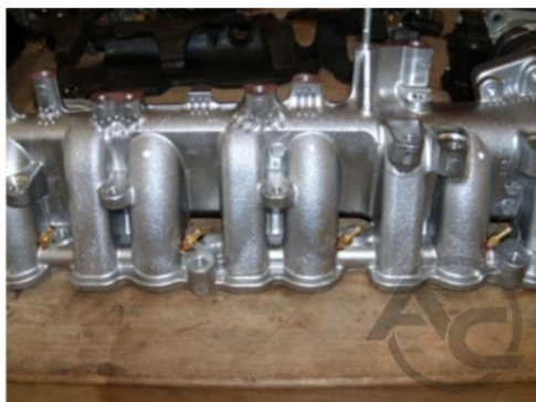
Картина 7. Место монтажа направленных сопел в коллекторе (вид снаружи)
