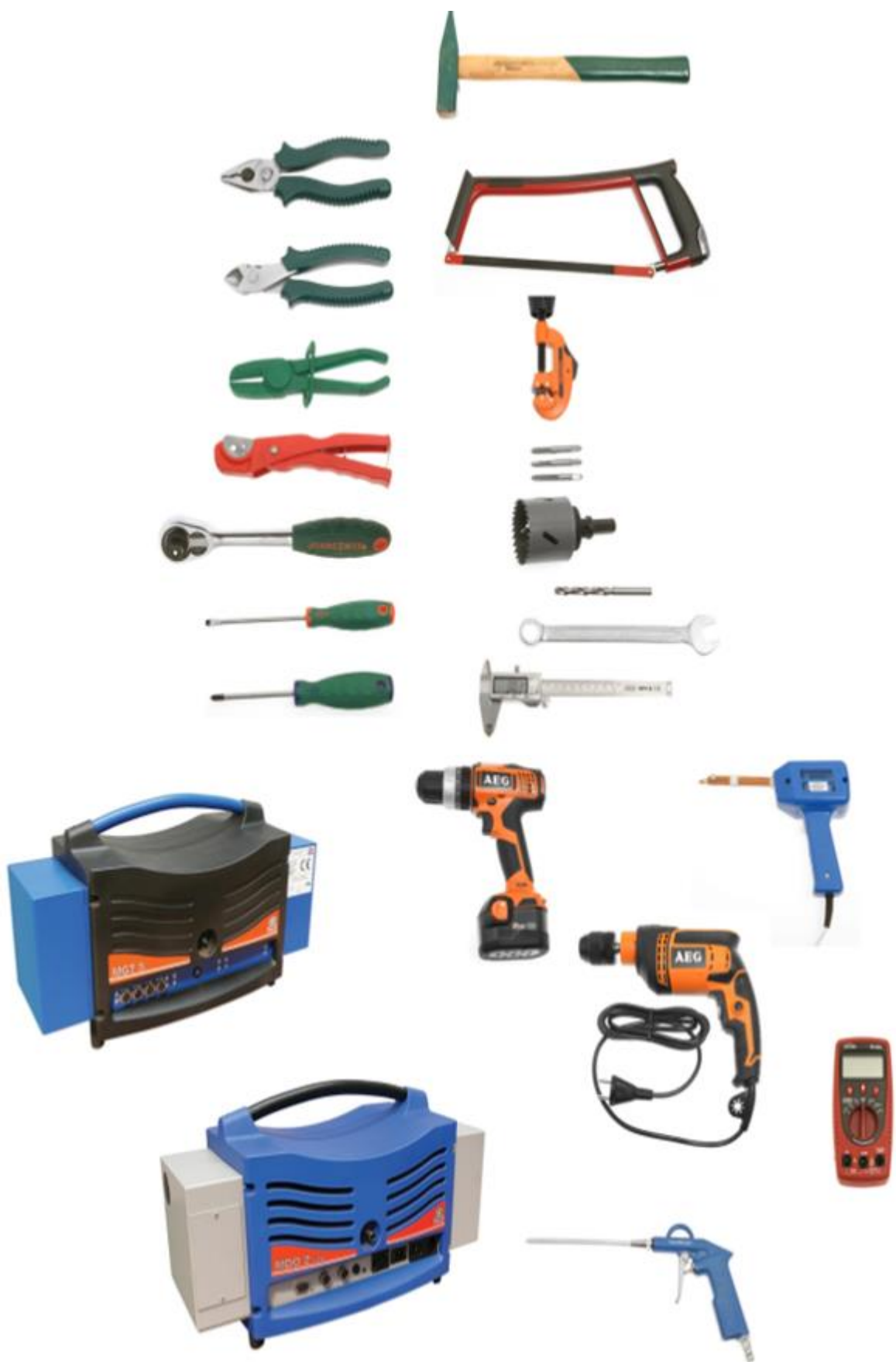
Картина 1. Инструменты, необходимые для монтажа установки DIESEL
