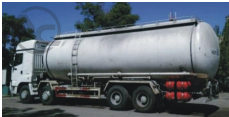
Картина 5. Установка цистерны CNG в грузовике
