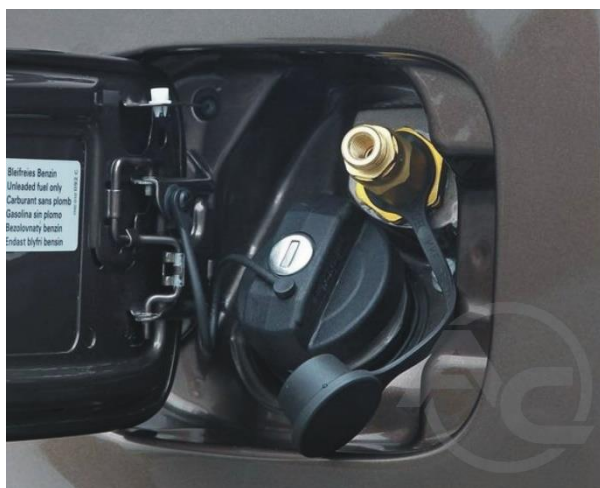
Картина 2. Монтаж заправочного клапана LPG
