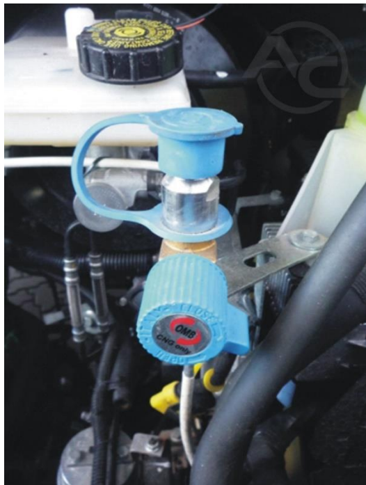
Zdjęcie 2. Montaż zaworu tankowania LPG
