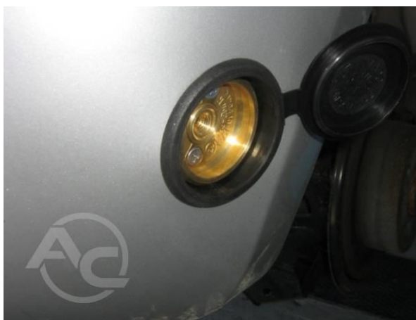
Zdjęcie 2. Montaż zaworu tankowania LPG
