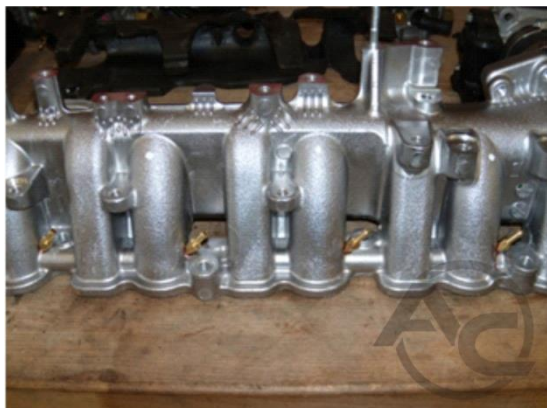
Zdjęcie 7. Miejsce montażu dysz w kolektorze (widok od zewnątrz)
