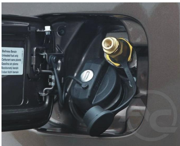
Zdjęcie 2. Montaż zaworu tankowania LPG
