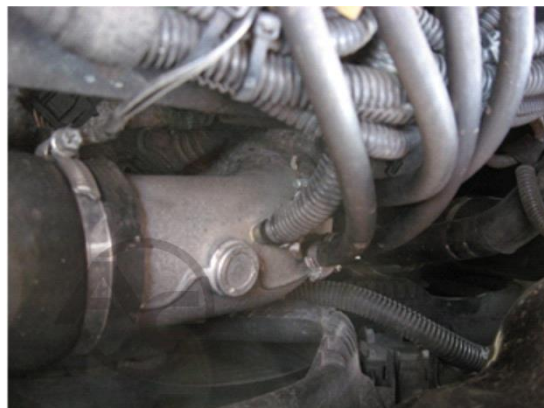
Zdjęcie 8. Miejsce montażu zbiorcze dysz za turbiną
