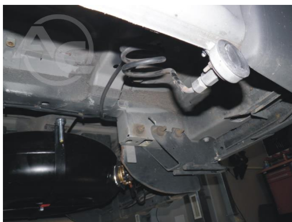
Zdjęcie 2. Montaż zaworu tankowania LPG
