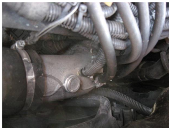
Foto 8. Lugar común de montaje de las toberas detrás de la turbina
