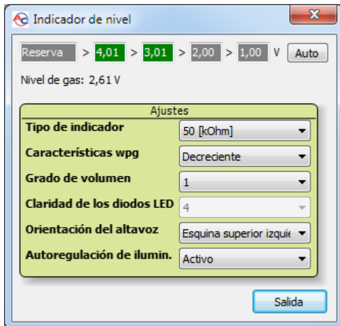
Figura 35. Vista de la ventana „Indicador de nivel de gas”.
