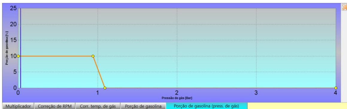
Figura 15. Mapa de injeção da gasolina adicional em função da pressão a que o gás se encontra.
